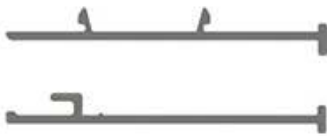
Figure 1.3 : Profil d'habillage du rail aluminium
